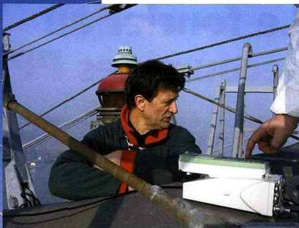
A gauche, un des quatre récepteurs bifrédence GNSS installés sur le tablier du pont de Normandie. Ci-dessus, Serge Garrigou au sommet.
